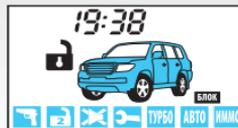
Для отключения блокировки кнопок брелка нажмите одновременно коротко кнопки 1 и 4 брелка:
